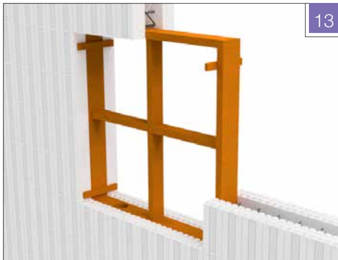
Fig. 13: Bruk tverrgående bord for fastholding av rammen. I underkant av rammen lages inspeksjonshull slik at betongstøpingen kan følges visuelt og slik at betongen kommer til under åpningen.
