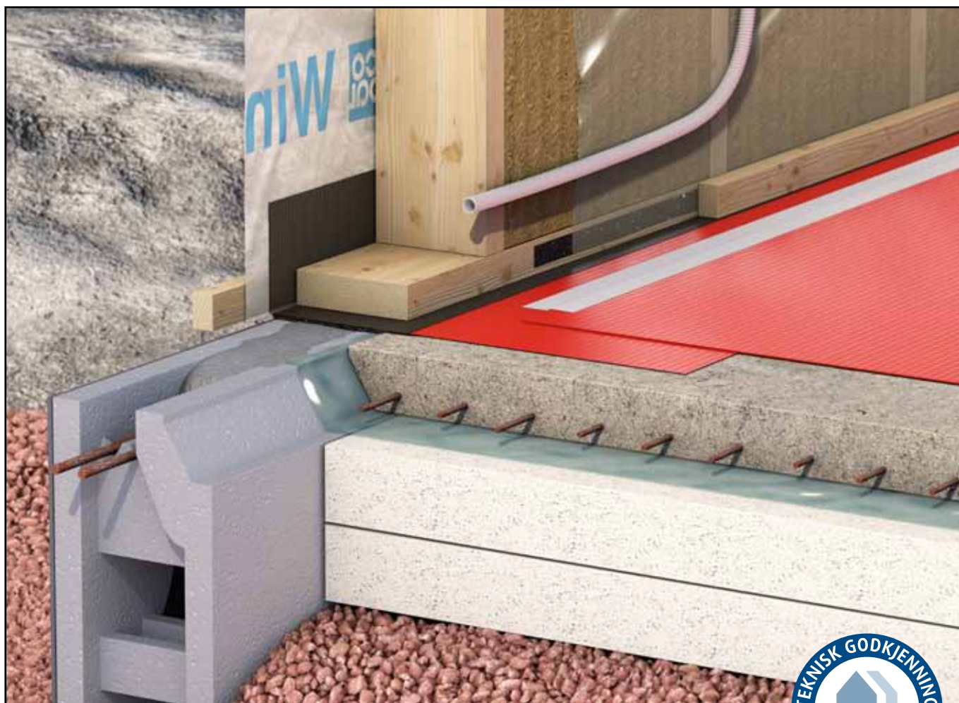
Icopal Svillemembran med radonflik, her vist koblet sammen med radonsperre i bruksgruppe C.
